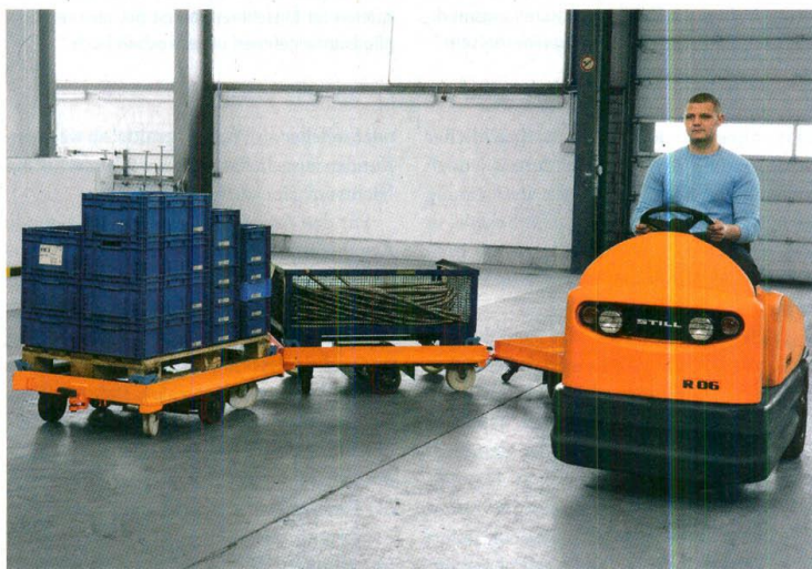
Bild 1: Im Rahmen getakteter Versorgungsprozesse transportiert der Routenzug vorkommissionierte Ladungsträger bedarfsgerecht an definierte Verbrauchsstellen.
