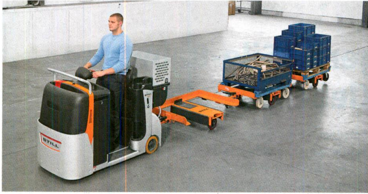
Bild 2: Ein Fahrer versorgt mit dem Routenzug die Produktionsabschnitte und kommt dabei ohne Stapler und Hubwagen aus.
